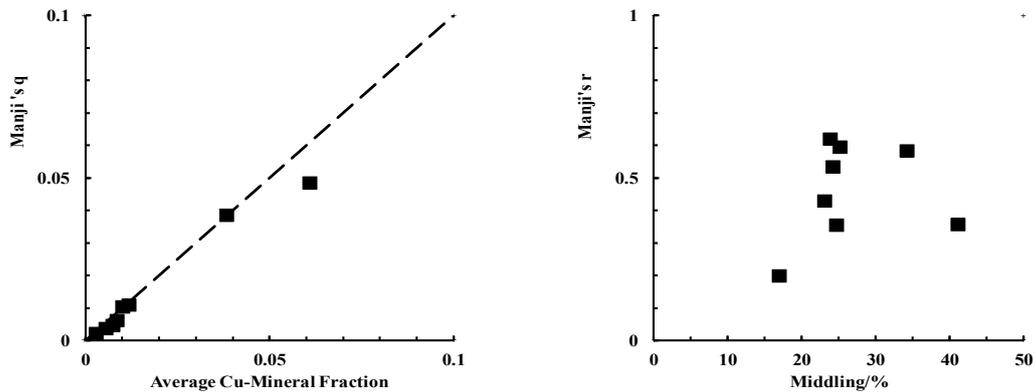
図6. 左) 試料の平均銅鉱物含有率と冪分布の水平部の位置を与える定数  $q$  との関係。右) 試料の片刃粒子の量と冪分布の曲率を与える定数  $r$  との関係。
