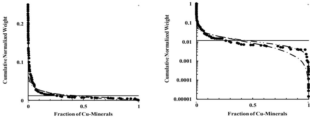
図 1. 試料 D にベータ分布と冪分布を当てはめた結果. 横軸は品位(銅鉱物含有率), 縦軸は高品位側からの累積頻度. 鉱石の銅鉱石含有率は 1.21%. 黒丸が実測値, 1 点鎖線がベータ分布の, 2 点鎖線が冪分布の回帰曲線. 縦軸の値が 0.01 付近の水平な実線は冪分布の  $q$  の値. 左は頻度分布図で品位が 0 となる頻度より下の部分, 右は頻度が対数表示. 頻度の表示が線形で上限が 1 の図では, 実測値, 回帰直線とも横軸とほぼ重なって, それぞれの識別が困難である.
