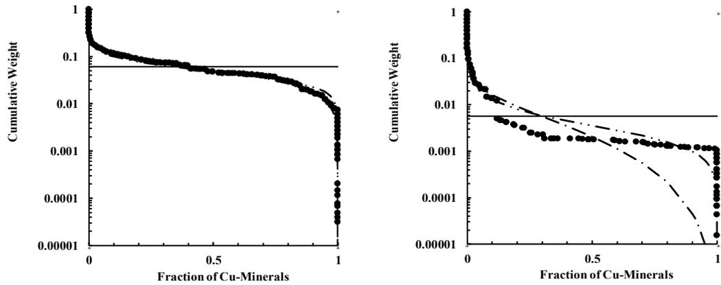
図 2. 対数に基づく評価値で最良を示した試料 A (左) と最悪を示した試料 F (右) の頻度分布図. 銅鉱物の含有率は, 試料 A (左) が 6.12%, 試料 F (右) が 0.57%. 黒丸が実測値, 1 点鎖線がベータ分布の, 2 点鎖線が冪分布の回帰曲線. 縦軸の値が 0.1 (左) と 0.01 (右) 付近の水平な直線は冪分布の  $q$  の値.
