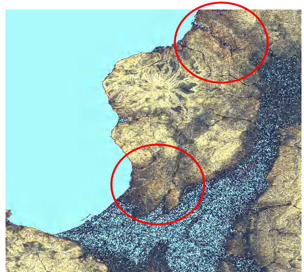
第10図 井上・若林(2002)の手法による地形解析結果からカラー合成した傾斜量図
