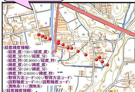
測地系の記載ミスにより、南東に約400mずれてプロットされたと推測される
