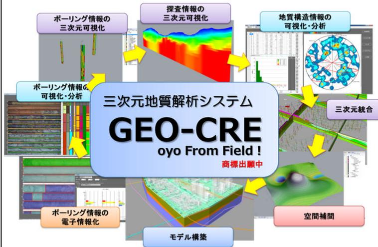
GEO-CRE (ジオクリ) は、地質踏査データや高品質ボーリングデータ、物理探査データ、地形データ等を速やかに見える化し、リアルタイムで現実的感覚のある三次元地質モデリングを可能とします
