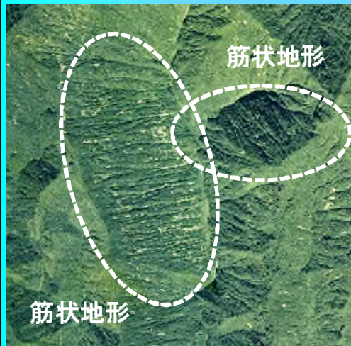
筋状地形(新潟県魚沼市): 空中写真では針先で引っ掻いたような筋状のパターンが判読される
