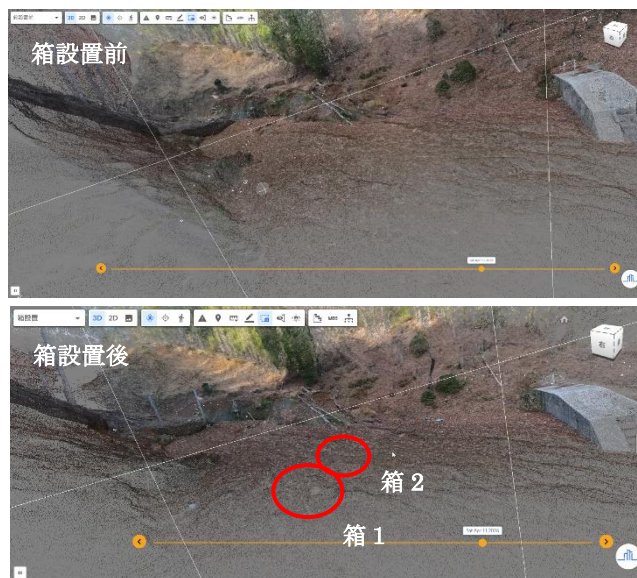
第3図 箱1, 箱2の設置前後の点群
